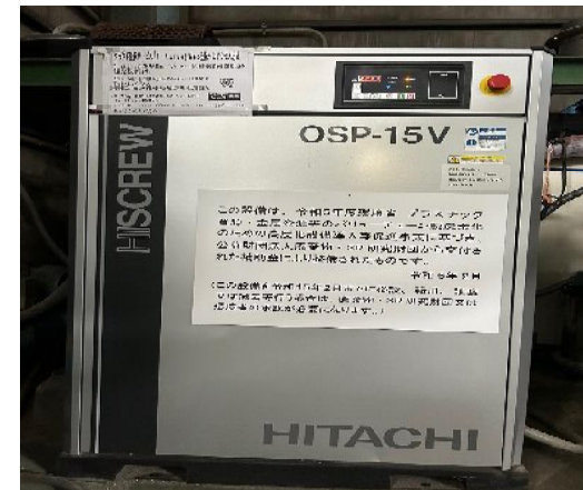
エアコンプレッサー
